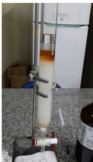
Figura 2.6: Cromatografia em coluna da fração diclorometânico na obtenção do composto FT-B (21-27) .
