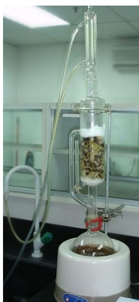
Figura 2.3: Extração das sementes com hexano em sistema Soxhlet.
