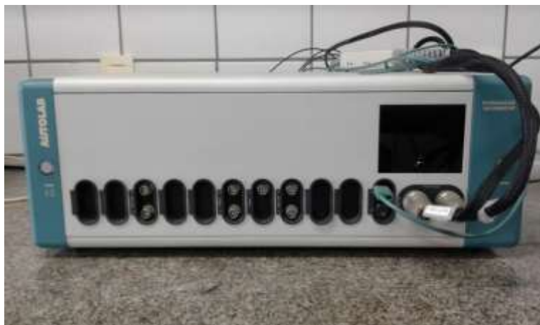
Figura 4: Potenciostato/galvanostato para medidas eletroquímicas.
