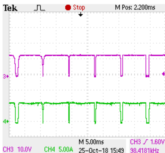
Figura 4.24 – Sinal de comutações das chaves primários do MIF.
