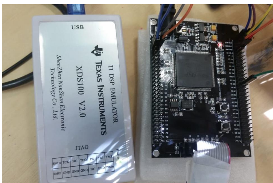
Figura 4.6 – Fotografia do DSP TMS320F28335
