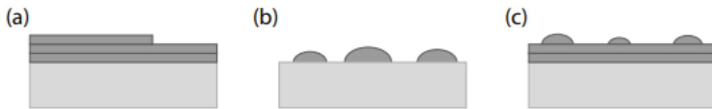
Figura 1 - Ilustração esquemática de diferentes modos de crescimento dependendo da relação entre energias superficiais. (a) Camada por camada (Frank van der Merwe), (b) Ilhas (Volmer-Weber) e (c) Camada mais ilha (Stranski-Krastanov).
