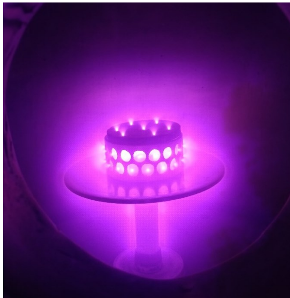
Figura 5 - Aspecto visual da formação do plasma na superfície da gaiola gerando efeito de multi-cátodos cilíndricos nos furos da gaiola e tampa.
