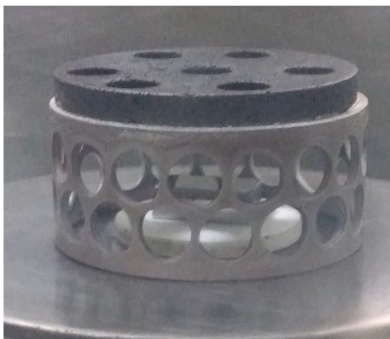
Figura 10 - Disposição da amostra de aço UNS S32750 sobre alumina e dentro da gaiola para tratamento.
