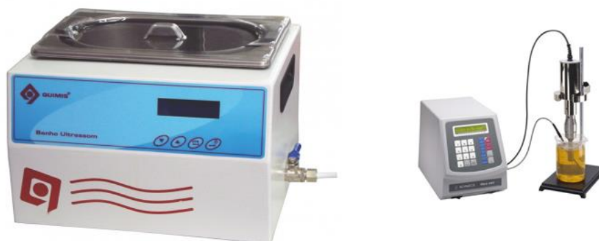
Figura 1. Equipamentos geradores de ondas ultrassônicas: banho (esquerda) e sonda (direita). Fonte: Google imagens.
