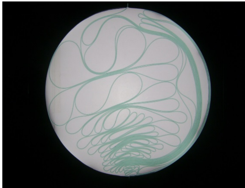
Figura 2.17: Padrão de empacotamento realizado com fio de nylon, na cavidade com diâmetro d = 22 cm.
