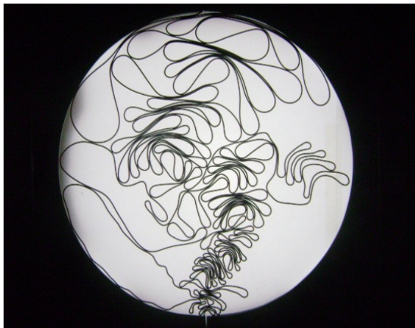
Figura 2.15: Padrão de empacotamento realizado com fio de cobre, na cavidade com diâmetro d = 22 cm.
